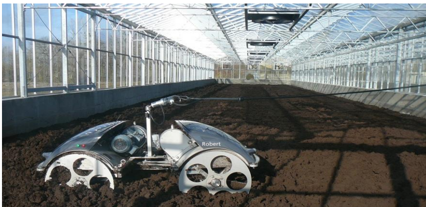
Figura 3. Estrutura interna do secador solar THERMO-SYSTEM Solar Dryer e a atuação do Eletric Mole. Fonte: PARKSON, 2016
